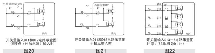
注1: DI1-DI2公共端为D1\*, DI3-DI6公共端为D1c, D1\*与D1c内部电气隔离; 现场施工时, 为简化接线, 可在仪表外部短接。
